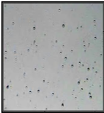
الشكل (2) وضح آثار جسيمات الفا في الكاشف الاثر النووي (CR-39)
