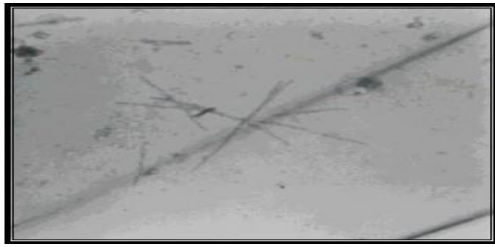
شكل (2) يمثل خمل النمط الاول بعد عملية التنقية باستعمال المجهر الالكتروني قوة 50000 x
