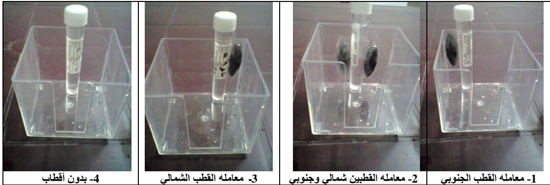
شكل (1) معاملة عينة مياه الساقية بالمجال المغناطيسي الثابت
